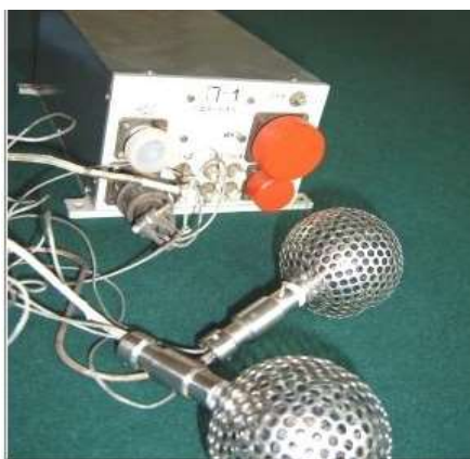
Фиг. 2. Първият български сондов прибор П-1 с датчиците СЙУ за директно измерване на параметрите на йоносферната плазма от борда на спътника „Интеркосмос-8“.
